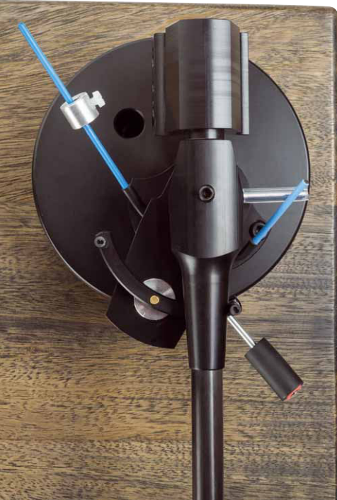
Die blauen Ausleger sind das Gestänge des Antiskating-Mechanismus am Tonarm
