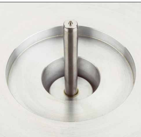
Die Tellerachse ist relativ dünn ausgefallen, die Lagerkugel klein: So sorgt man für ein sehr leises Lager
