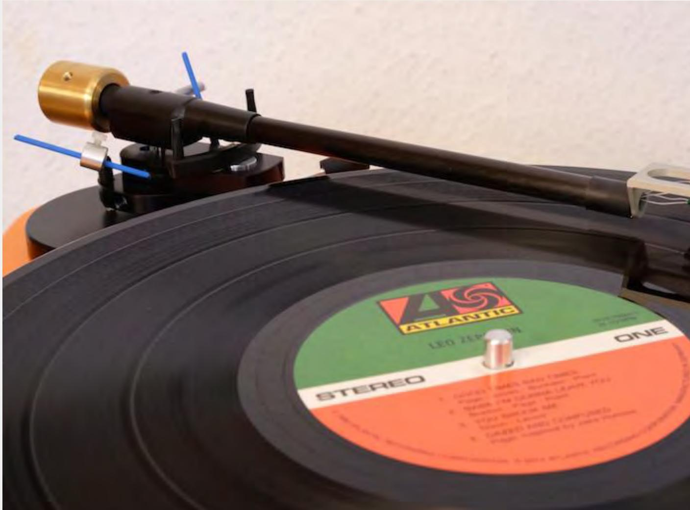
*Das Antiskatingeinrichtung am Cornet 1 wirkt rudimentär, funktioniert aber tadellos. Sie besteht aus dem blauen Draht und einem Stelling, der je nach gewünschtem Antiskating in einer bestimmten Abstand zum Drehpunkt befestigt wird.*
