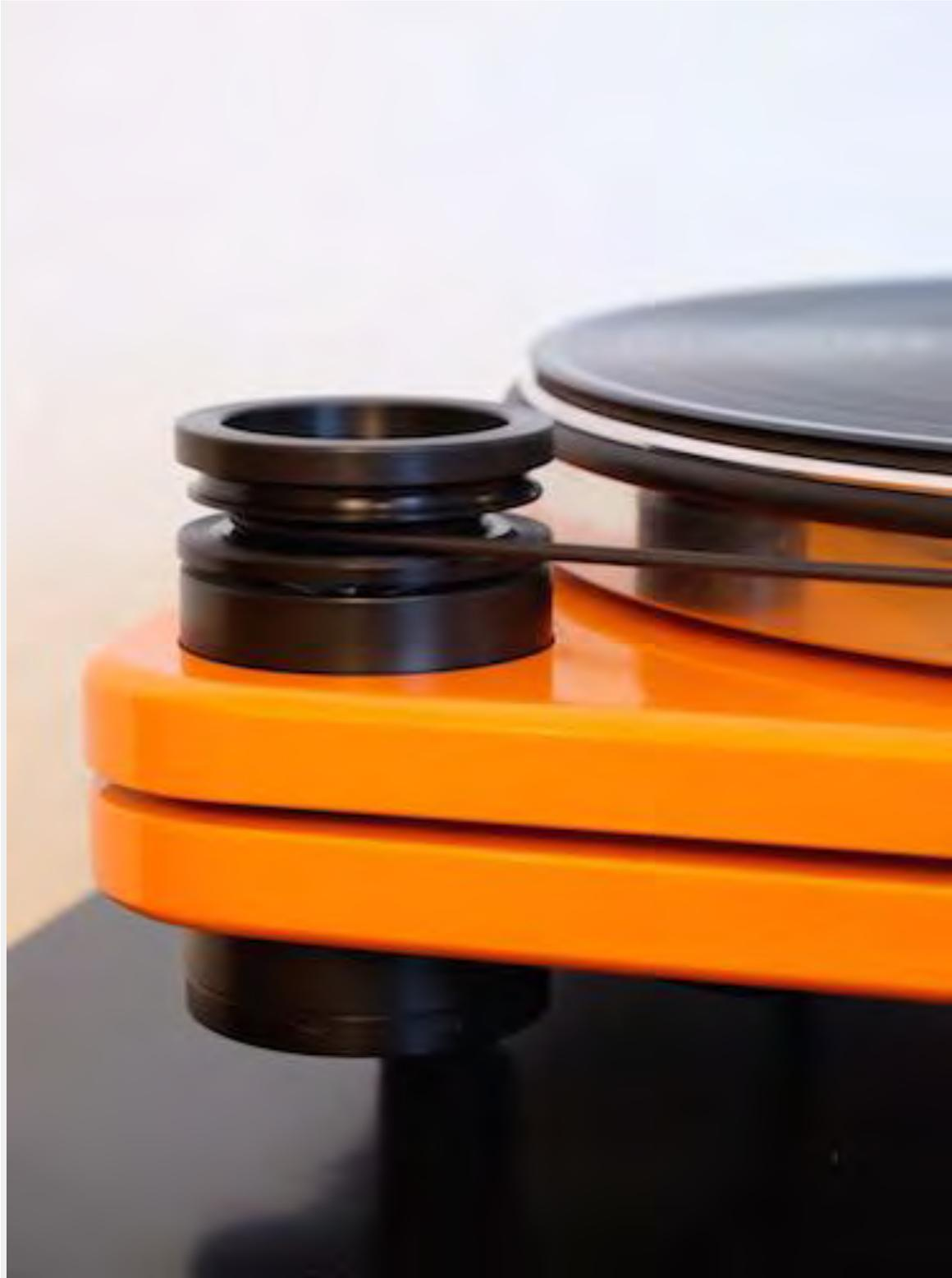
*Der Motor befindet sich in einer Motordose aus Metall genau gegenüber des Tonarms. An dieser Position nimmt er den geringsten Einfluss auf den empfindlichen Abtastvorgang. Für den Wechsel auf 45 Umdrehungen wird der Riemen von der kleinen in die größere Kerbe im Pulley umgelegt.*
